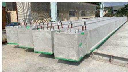
工場で製造された橋げた
