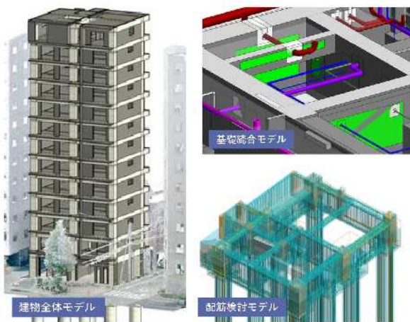
当社施工現場でBIMを活用したフロントローディングを試行 設計段階での課題抽出・解決による設計品質の向上への取り組み
