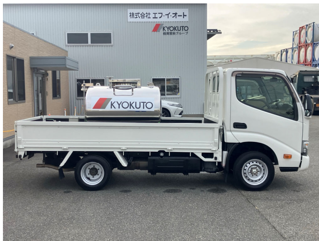
オンデッキ型給水タンク搭載車両（極東開発工業株式会社との共同開発）
