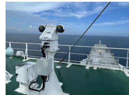
旋回台に設置された 超高感度カメラ での船外監視
