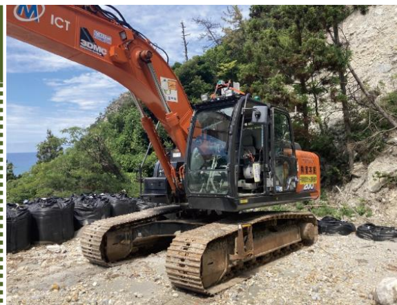
3D遠隔操作ソリューションを 実装した建設機械(輪島市)
