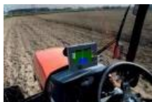
農作業の負担軽減のための 農業機械向け直進自動操舵補助装置
