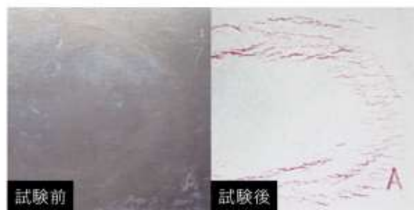
アルミ焼割れ
