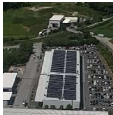
倉庫棟屋根に設置した約1,000枚の太陽光パネル
