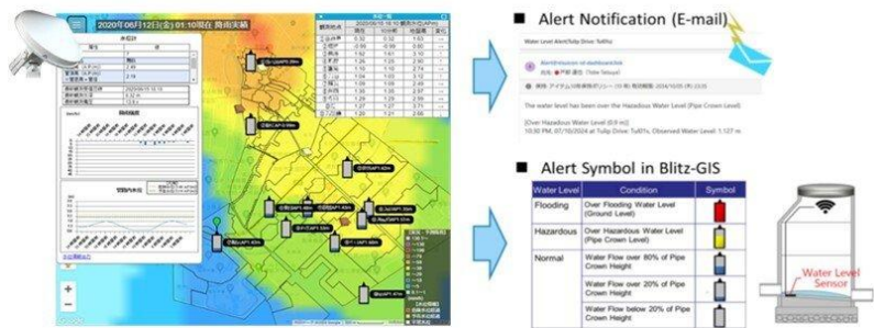
「リアルタイム雨水管理システム（Blitz GIS）」を用いた雨水管理のスマート化イメージ
