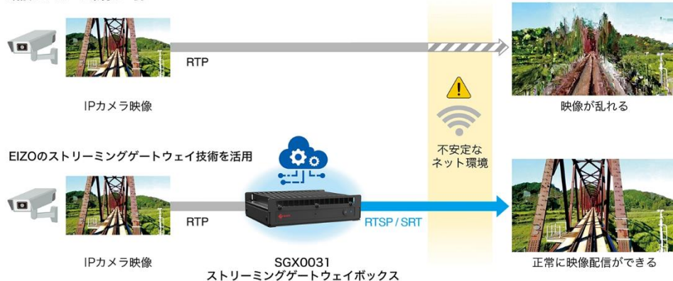
既設のIPカメラ環境の一例
